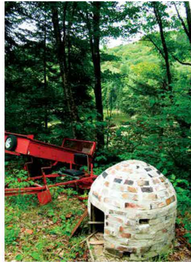
Dans ce four miniature déplaçable d'une hauteur de 90 cm, la carbonisation du bois nécessite une journée, alors qu'elle en prend une quinzaine dans les fours plus grands.
